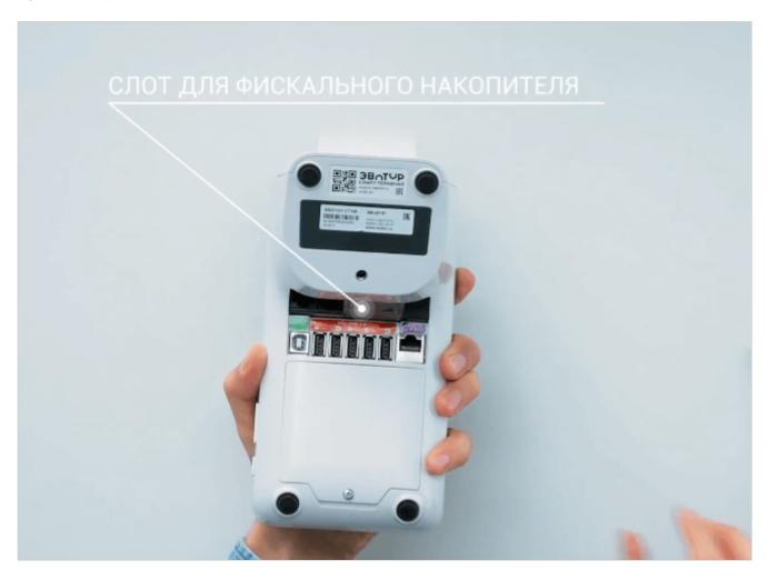
Здесь же — разъемы и порты, чтобы подключить блок питания, сканер, принтер этикеток, весы и пинпад:
